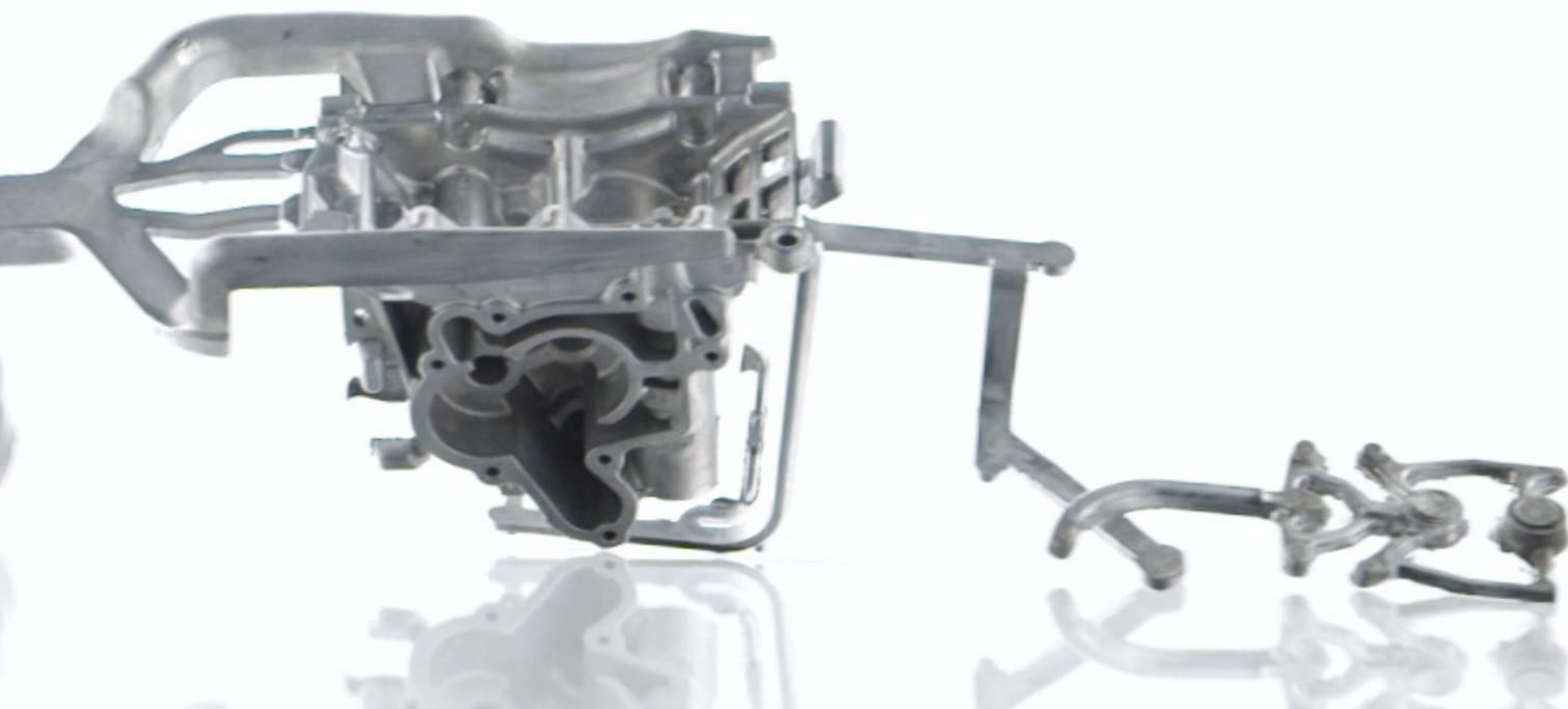
come sia necessario procedere con un approccio statistico che tenga conto della vera natura della geometria da analizzare. La simulazione di colata procederà poi nell'identificare le zone critiche, in modo che il progettista possa fornire un componente ottimizzato nei confronti del processo di pressocolata.
