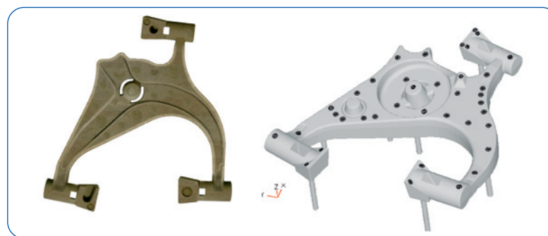
Fig. 5 - Anima - Modello 3D per la simulazione - Cortesia TEKSID.
