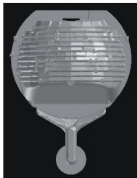
**Fig. 1** Stampata con sistema di colata.
