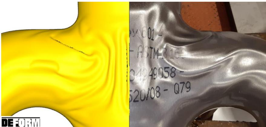
Fig. 8: Risultati della prova stampo a singola stazione. Confronto fra il tubo con le grinze e i risultati della simulazione di imbutitura a singola stazione. Eccellente allineamento DEFORM-realtà, affidabilità garantita per l'intercettazione delle grinze
