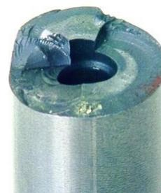
Notare la direzione della frattura composta, con visibile propagazione della frattura nelle direzioni assiale e radiale
